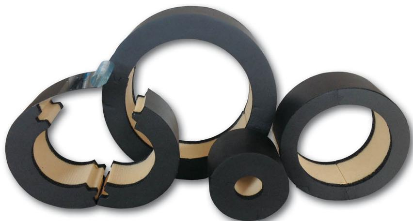
**ISOCLAMPS** werden hauptsächlich für die Beseitigung von Isolierungsfugen und für die Vermeidung des Entstehens von Wärmebrücken bei der Halterung von isolierten Röhren (hergestellt durch Führungskragen oder Metalklammer-Bügel) bei Kälte- oder Wärmeerzeugungsanlagen verwendet. Geeignet für Anwendungen bei Temperaturen zwischen  $-45^{\circ}\text{C}$  und  $+105^{\circ}\text{C}$ .
