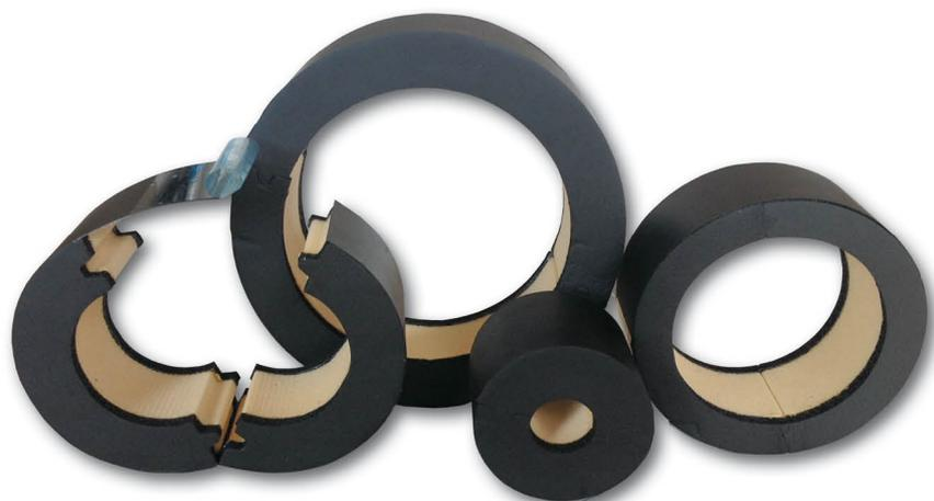
Les raccords **ISOCLAMPS** sont utilisés pour éliminer les variations de résistance thermique et réduire la possibilité d'un pont thermique, pendant le soutien de la conduite isolée (colliers ou supports métalliques), dans les installations de réfrigération ou de chauffage. Ils sont préconisés pour les applications où la température est comprise entre  $-45^{\circ}$  et  $+105^{\circ}$ C.
